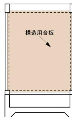
図6 構造用合板による耐震壁
